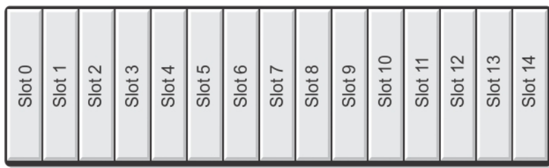
Figure 7. Logements de disque de boîtier de stockage Dell PowerVault MD1000
